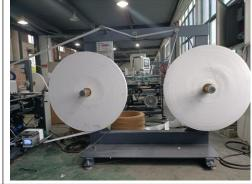
2.使用自动纠偏确保手柄贴片在正确位置 use Arise EPC to ensure the handle patch on the right position
