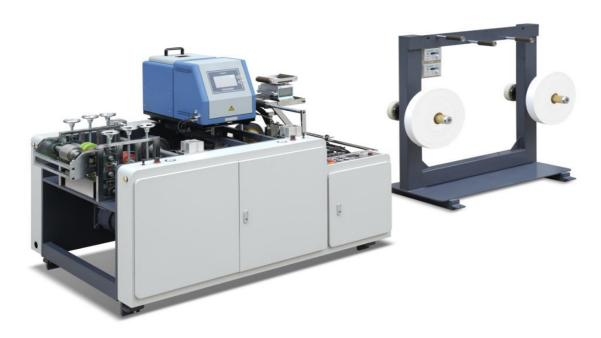
本机主要配套半自动纸袋机。 它可以用纸绳快速生产纸把手,在后续生产中,可以将手把人工粘贴在没有把手的纸袋上,制成手提纸袋。 本机以两卷窄窄的纸卷和一根纸绳为原料,将碎纸片和纸绳粘在一起,逐渐切断形成纸手把。 此外,该机还具有自动计数和上胶功能,可大大提高用户后续加工操作的效率。
